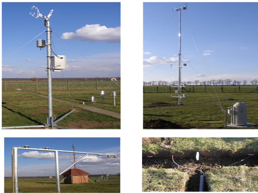
2. ábra. Az alapéghajlati mérőhálózat debreceni állomása (Nagy Zoltán, OMSZ felvétele). Fent: direkt árammérések (impulzus, CO 2 , szenzibilis és latens hőáram), szélesebesség, hőmérséklet és nedvesség profil mérések (jobbra). Lenn: sugárzásmérő állvány (balra), talaj energiaháztartás mérések (talajhőmérséklet, -nedvesség és -hőáram), jobbra.
