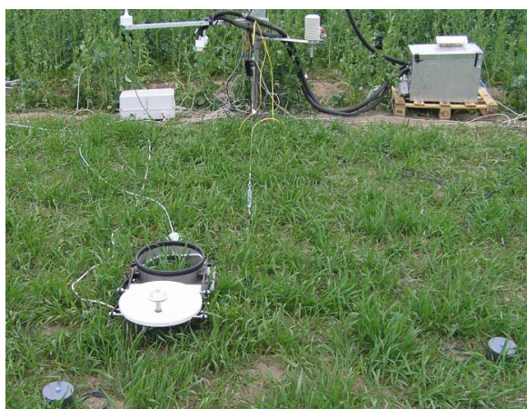
4. ábra. Automata, mikroszámítógéppel vezérelt dinamikus kamra a talaj \text{CO}_2 áramának mérésére, éppen nyitott állapotban, valamint az \text{N}_2\text{O} és \text{CH}_4 mérésére szolgáló két kis statikus kamra (a kép alján a jobb- és baloldalon) a dániai mérési expedíción (Bordás Árpád felvétele).
