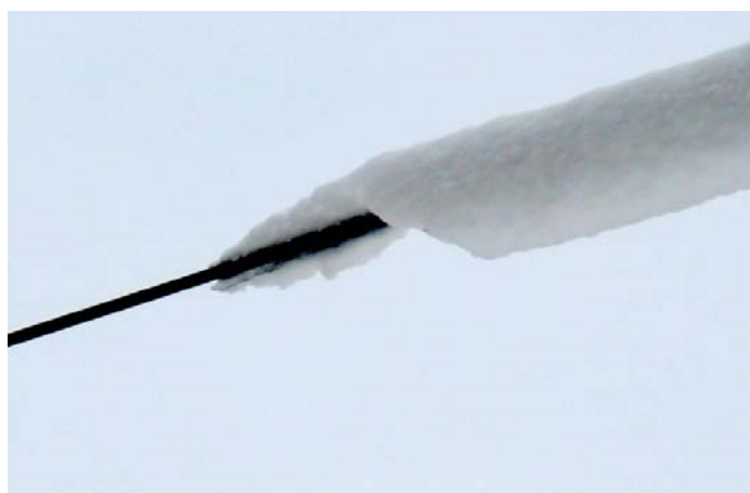
2. ábra. Szabadvezetéken kialakult, körszimmetrikusan lerakódott tapadó hó. Forrás: E.ON Észak-dunántúli áramhálózati Zrt. 2009. február 9. Bakony
