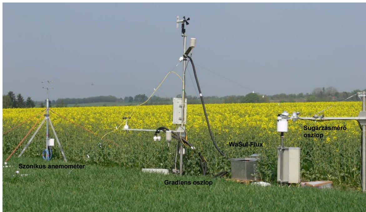
3. ábra Mikrometeorológiai állomás a 2009. májusi dániai (Bjerringbro) EU6 NitroEurope mérési kampányon. Balról jobbra: szonikus anemométer, gradiens mérő oszlop, Wasul-Flux - fotoakusztikus ammóniamérő, csapadékmérő, tápegység és adatgyűjtő modul, sugárzásmérő oszlop (Pogány Andrea felvétele).
