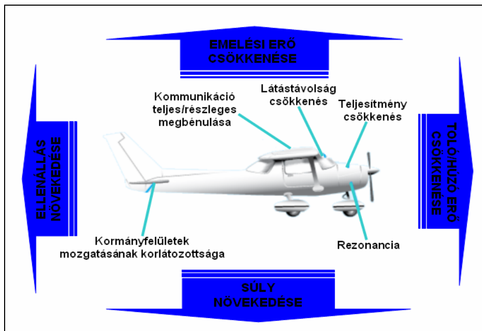
2. ábra: A felületi jegesedés lehetséges hatásai merev szárnyú repülőgépek esetén
