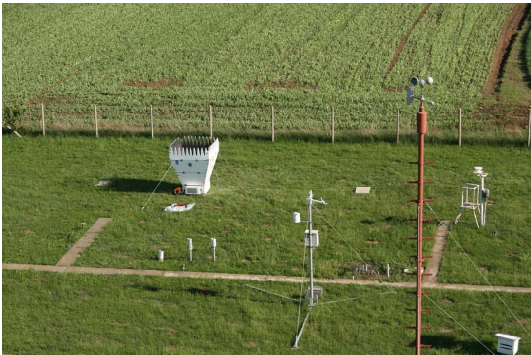
2. ábra: PCS.2000-24 típusú Doppler-SODAR berendezés a DE Agrometeorológiai Obszervatóriumának területén
