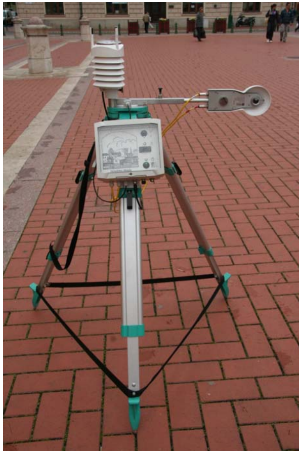
1. ábra: Mobil mikroklíma mérési egység
