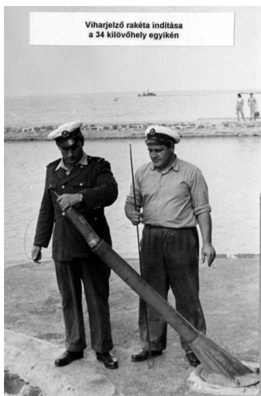
1. ábra: Viharjelző rakéta kilövése az 1960-as évekből. A sárga rakéták az erős szélre (40–60 km/h), a piros rakéták a viharos (>60 km/h) szélre figyelmeztettek. A rendszer egészen az 1980-as évek közepéig működött
