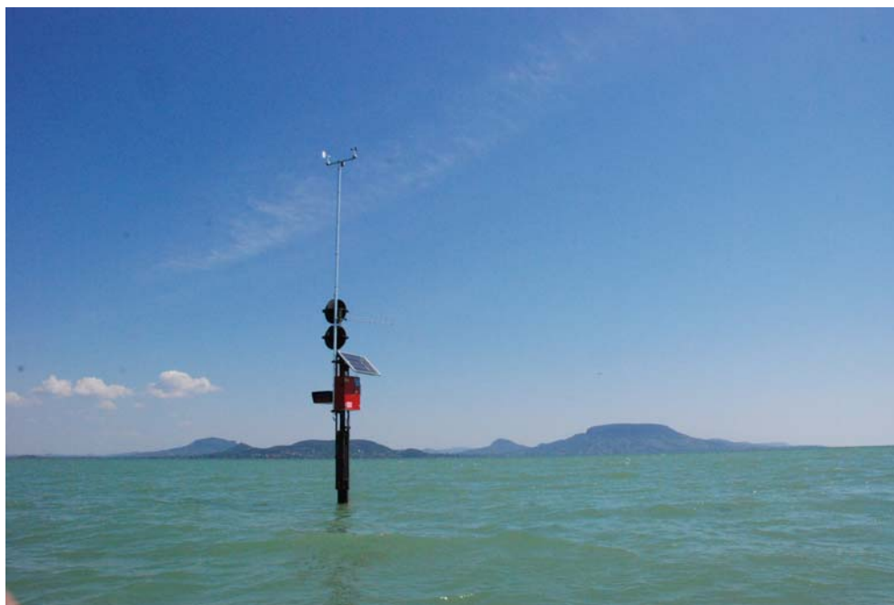
3. ábra: Automata szélműszer Szigliget és Balatonmária között. A napelemtől működő berendezés a LIFE project keretében készült, később OMSZ műszerekkel lett felszerelve és az RSOE rádiós rendszere gyűjti az adatokat
