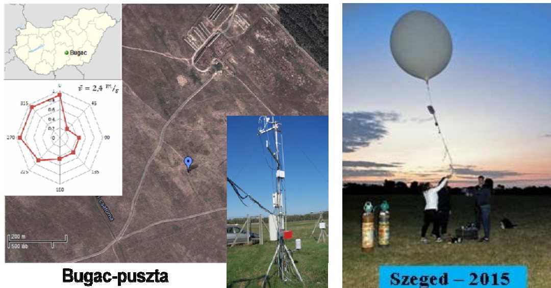
6. ábra: A bugac-pusztai mikrometeorológiai mérőhely (baloldalon). A turbulens árammérések 10 Hz-es felbontással folytatók. Jobboldali kép: kötött ballonos mérés a szegedi repülőtéren (Tordai Ágoston felvétele)
