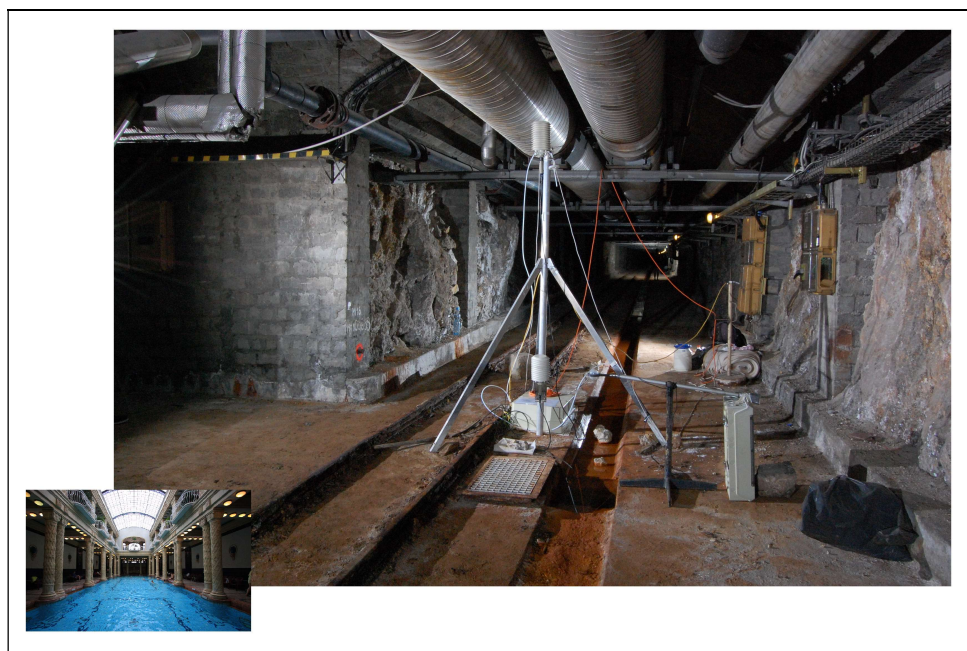
4. ábra: Mikroklima mérések a Gellért fürdő alagútjában. Középen a 2 m-es mérőoszlop a két Vaisala hőmérséklet-relatív nedvesség mérő műszer árnyékolóval (0,5 m és 2 m), jobbra a Q7-es sugárzásegyenleg-mérő, illetve távolabb a fal hőmérsékletét mérő infra-hőmérő.
