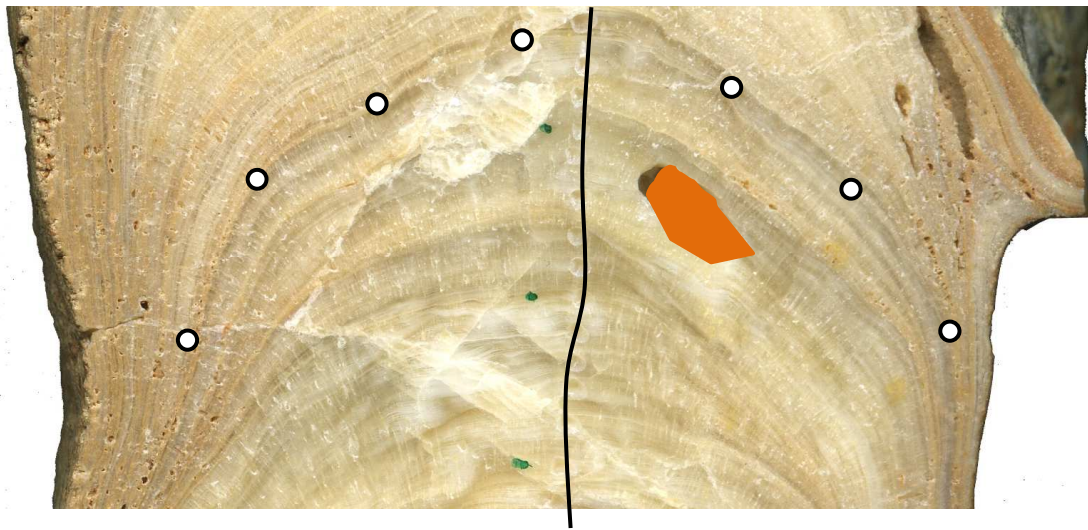
4. ábra: Egy kiragadott felület a Hendy-teszthez. A fekete vonal az izotópos vizsgálatok nyomvonalát, a narancssárga jelölés a kormeghatározáshoz szükséges mintavétel helyét jelöli, a fehér körök pedig a teszthez szükséges minták helyei.
