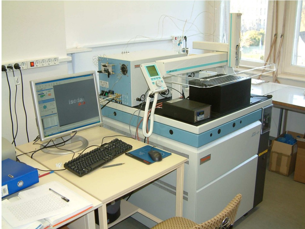
5. ábra: Finnigan delta plus XP típusú vivőgázos tömegspektrométer az MTA GKKI laborjában
