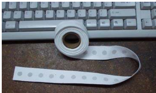
11. ábra: Kvarcszűrő-tekercsre gyűjtött minta (forrás: http://mageesci.com )
