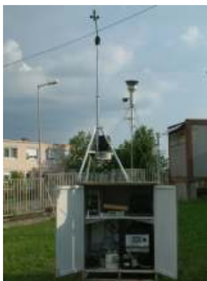
6. ábra: A paksi környezetellenőrző laboratórium udvarán elhelyezett levegőminőségi mérőkonténer
