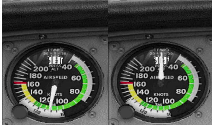
39. ábra. A Pitot-cső jegesedésének hatására történő sebességi adatvesztés repülés közben.
