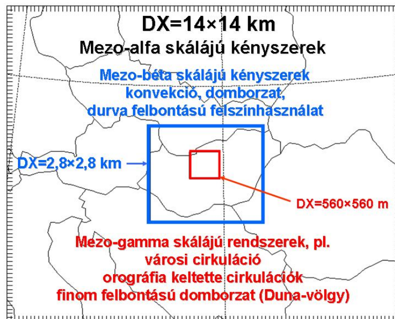
9. ábra. Budapest városhatásának modellezésére használhatjuk például a fenti elrendezést. Esetünkben az ECMWF 20 km-es adataiból kis torzítású interpoláció nyerhető a mother-domainra, amely az időjárási front nagyságrendű folyamatokat már leírja.
