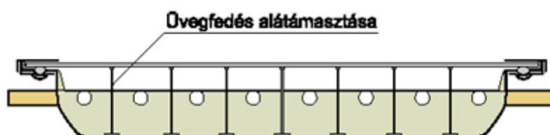
6. ábra: Vákuumos síkkollektorok felépítése
