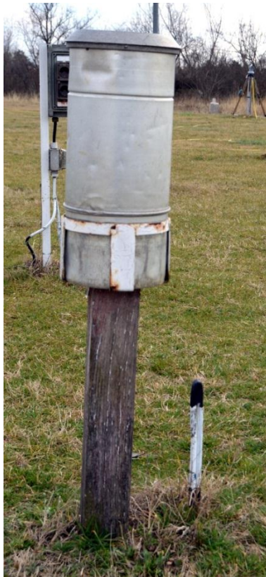
4. ábra: Oláh-Csomor-féle csapadékmérő az Országos Meteorológiai Szolgálat pestszentlőrinci állomásán
