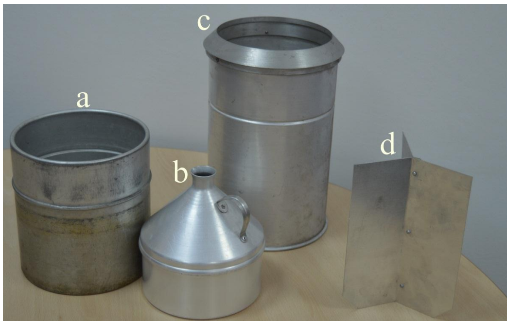
5. ábra: Oláh-Csomor-féle csapadékmérő részei: a) tartóedény, b) gyűjtőedény, c) felfogóedény, d) hókereszt
