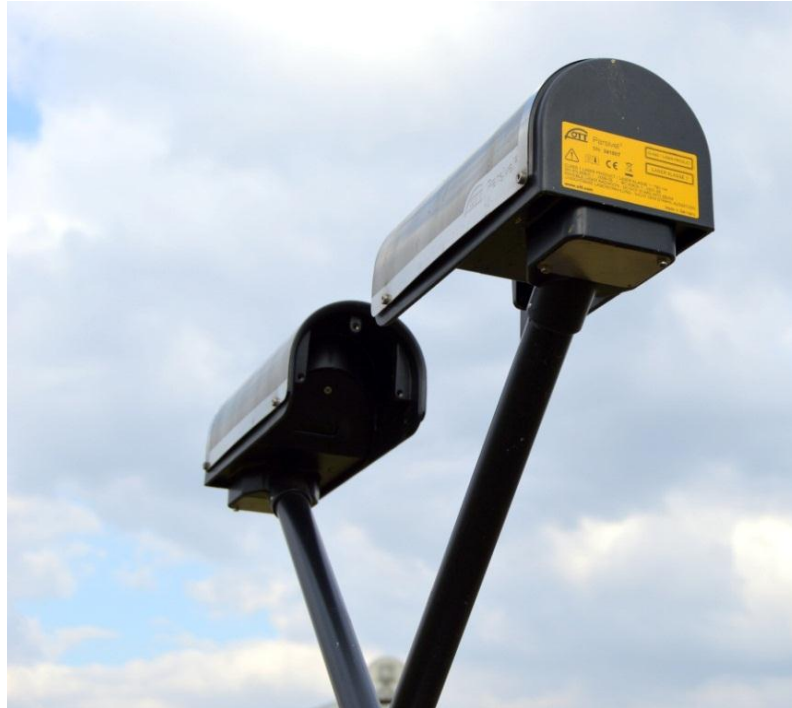
21. ábra: A két egymással szemben elhelyezett szenzorfej, tetején a fröccsenésgátló
