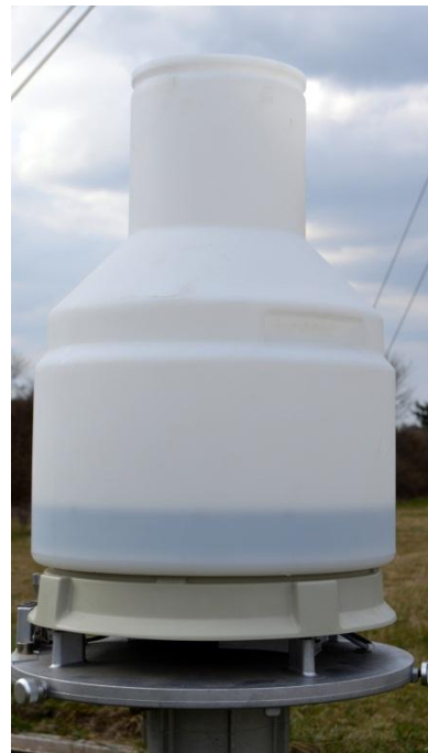
12. ábra: Mérlegen elhelyezett gyűjtőtartály
