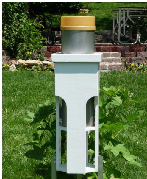
12. ábra NOAA standard csapadékmérő az Egyesült Államokban (forrás: srh.noaa.gov)
