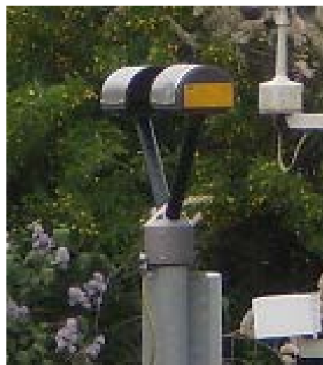
18. ábra Lézeres cseppspektrum-mérő Budapest-Pestszentlőrincen
