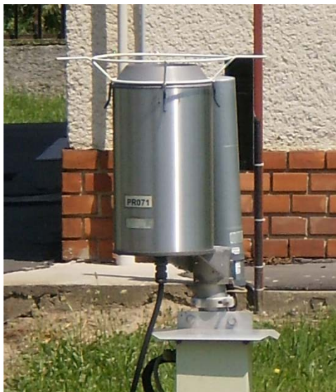
15. ábra Automata billenőedényes csapadékmérő Győr-Likócson
