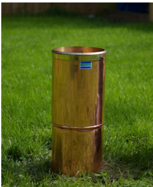
11. ábra Angol (5 inches) csapadékmérő Otter Valley-ben (forrás: ottervalley.co.uk)
