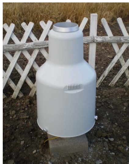
17. ábra Tömegmérés alapú csapadékmérő Sopronhorpácson
