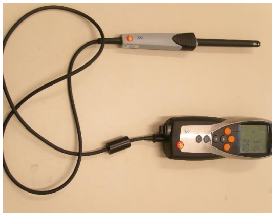
6. ábra: A méréshez használt Testo-635 típusú műszer
