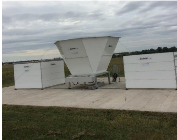
4. ábra: A Budapesti Liszt Ferenc Nemzetközi Repülőtéren elhelyezett monostatikus SODAR rendszer (középen). A SODAR-hoz egy RASS bővítmény is csatlakozik, amelynek antennái találhatók két oldalt (saját fotó).
