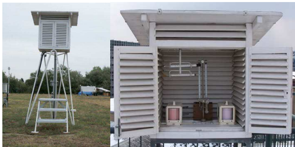
1.-2. kép: Stevenson-féle hőmérőházak: a bal oldali kép a MILOS-500 automatával felszerelt baja-csávolyi, a jobb oldali pedig a Budapest, Kiatibél Pál utcai hőmérőház (hagyományos T , T_w , T_n , T_x hőmérőkkel).
