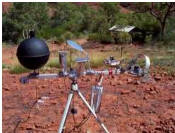
3. kép: Macquarie Egyetem műszere a WBGT index méréséhez.
