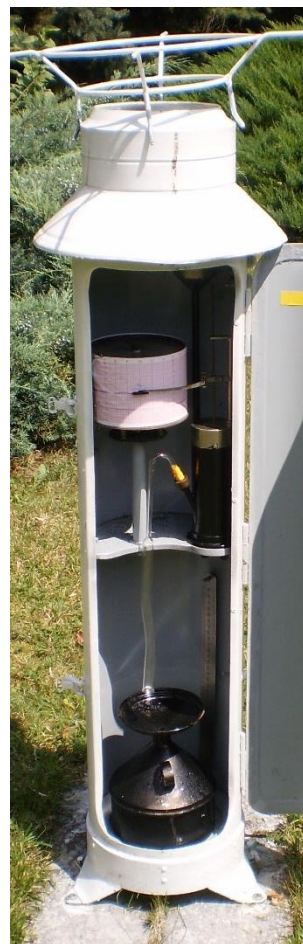
10. ábra Hellmann-rendszerű csapadékiró Sopron-Kuruudombon
