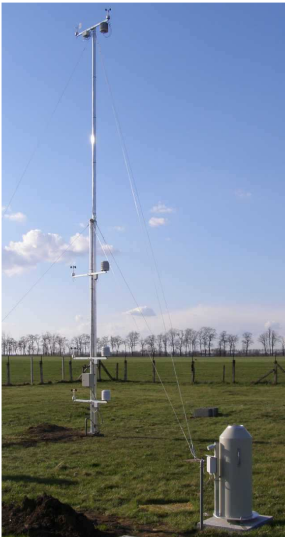
7. ábra. A 10 méteres mérőtorony a lég-hőmérséklet, légnedvesség és a szélesség gradienseinek meghatározására (az előtérben egy PG200 típusú súlymérési elven működő csapadékmérő)
