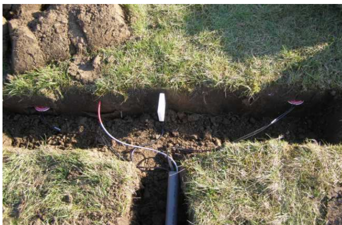
9. ábra. A talajhőmérséklet, a talaj mélyebb rétegeibe jutó hőáram és talajnedvesség mérők a felszíni energia egyenleg talaj komponensének meghatározásához.
