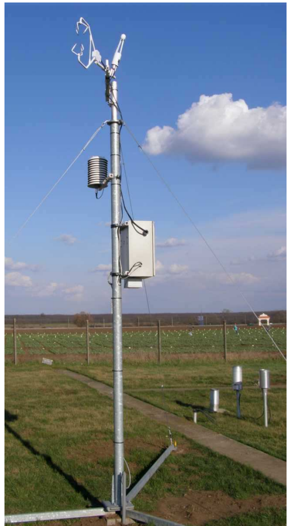
8. ábra. A Campbell CSAT3 típusú szonikus anemométer, valamint LICOR 7500 típusú H 2 O, CO 2 koncentráció-mérő berendezés 4 méteres mérőtoronyon a szenzibilis és látens hőáram meghatározása eddy-kovariancia módszerrel.
