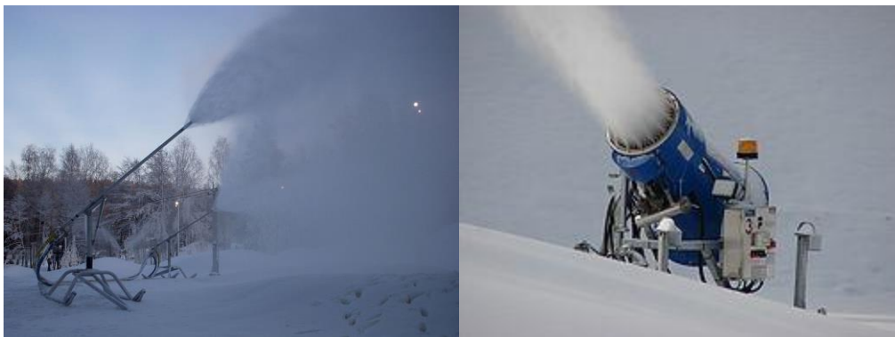
4. ábra: Bal oldali képen a lándzsás berendezés, jobb oldalon a ventilátor berendezés látható (6 – Hóágyú)
