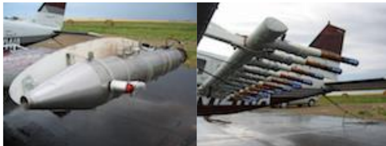
10. ábra: Szárnyvégi ezüst-jodid generátor (bal) és helyben égő fáklyák (jobb) felhőmagvasítást végző repülőgépekre felszerelve [11 – nawmc.org]
