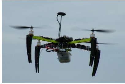
13. ábra – Kötött ballonos (fent) és kvadrokopteres felszállások (lent) a 2015-ös szegedi expedíció (PABLS'15) intenzív mérési periódusaiban. A cél hőmérséklet- és nedvesség vertikális profiljainak vizsgálata.
