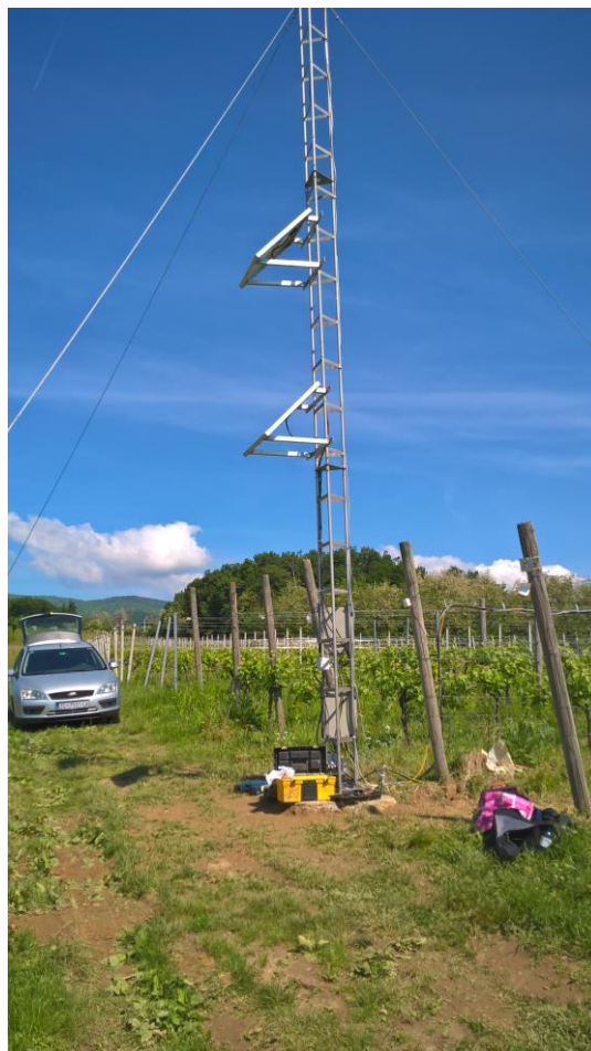
30. ábra – Zágrábi mikrometeorológiai mérések 2017-ben. Balra az ELTE műszerdoboz, benne a Campbell Scientific CR23X adatgyűjtő. Jobbra a Zágrábi Egyetem mérőtornya, melyre az áramellátást biztosító napelemek is kerültek.
