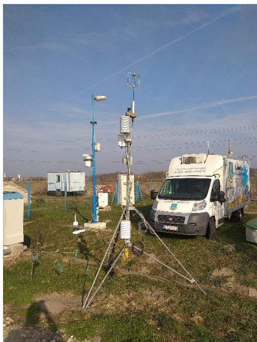
33. ábra – A 2018-2019-es téli ködmérési expedíció műszerezettségének részlete. Balra a sióuti mérőoszlop tetején a 10Hz-es felbontású Gill anemométerrel. A háttérben a Veszprémi Egyetem Környezetvédelmi Mobil Mérőlaboratóriuma. Jobbra fent az OMSZ Marczell György Főobszervatóriumában elhelyezett Eddy-kovariancia-mérőoszlop (BGME), háttérben a 30 m-es torony, melyen a profilméréseket végeztük.
