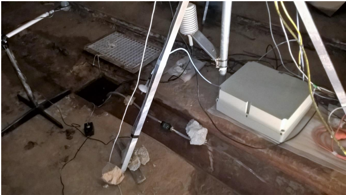
19. ábra – A Gellért-táró kísérlet során telepített mérőrendszer részlete. Középen látható a termálvíz-forrás (zsomp) és az abból a csatornába szivattyúzott víz.
