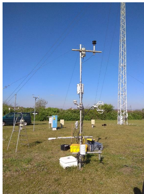
33. ábra – A 2018-2019-es téli ködmérési expedíció műszerezettségének részlete. Balra a sióuti mérőoszlop tetején a 10Hz-es felbontású Gill anemométerrel. A háttérben a Veszprémi Egyetem Környezetvédelmi Mobil Mérőlaboratóriuma. Jobbra fent az OMSZ Marczell György Főobszervatóriumában elhelyezett Eddy-kovariancia-mérőoszlop (BGME), háttérben a 30 m-es torony, melyen a profilméréseket végeztük.
